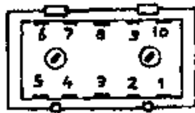
GELUID MF. TRAFU 1, 2, 3 SOUND IF. TRANSF. TONZF. ÜBERTRAGER AT 1011
